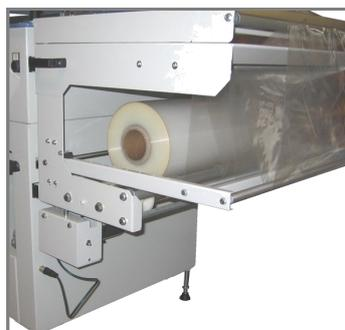
**Dériveur de film assisté** par un moteur électrique pour faciliter le débobinage du film.
