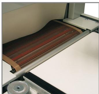
**Tapis à maille téflon**, principalement pour l'utilisation avec du film PE. Ce tapis est fixé au dessus du tapis d'origine à barreaux siliconés.
