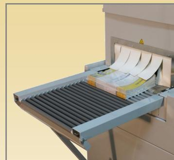
**Tapis de sortie inclinable** à rouleaux libres pour permettre la récupération des produits en sortie.
