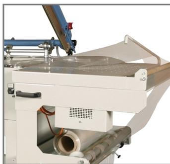
**Table soufflante** - Cette option permet par un soufflé d'air de laisser le film ouvert en permanence au dessus du plateau d'introduction.
